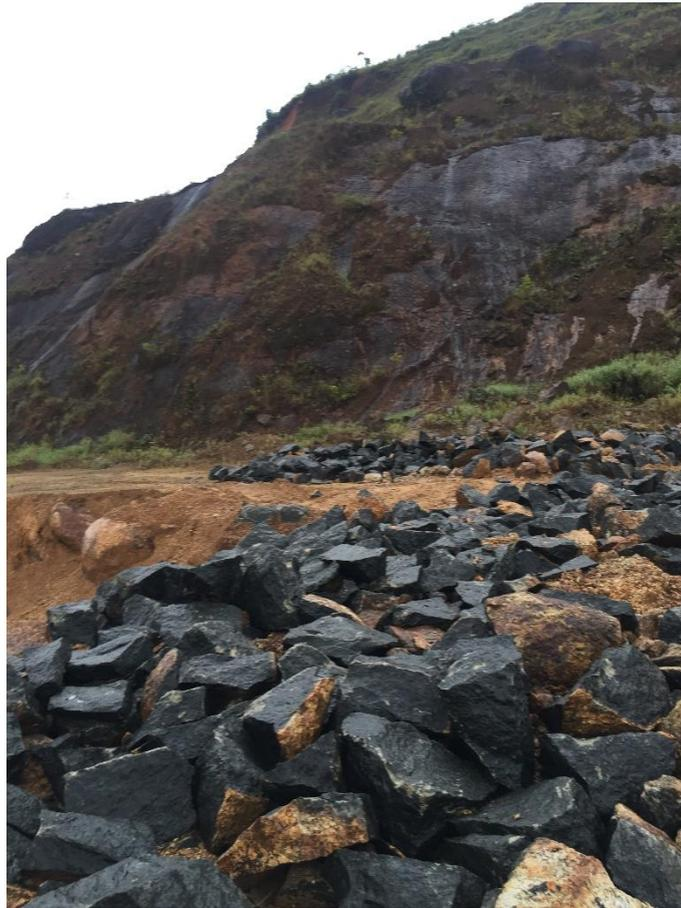
Figura 19 – Área de estocagem dos blocos removidos da frente de lavra e prontos para a alimentação do britador primário.
