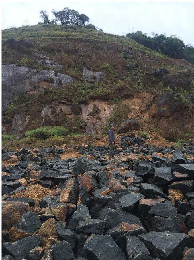
Figura 21 – Área de estocagem dos blocos removidos da frente de lavra e prontos para a alimentação do britador primário.
