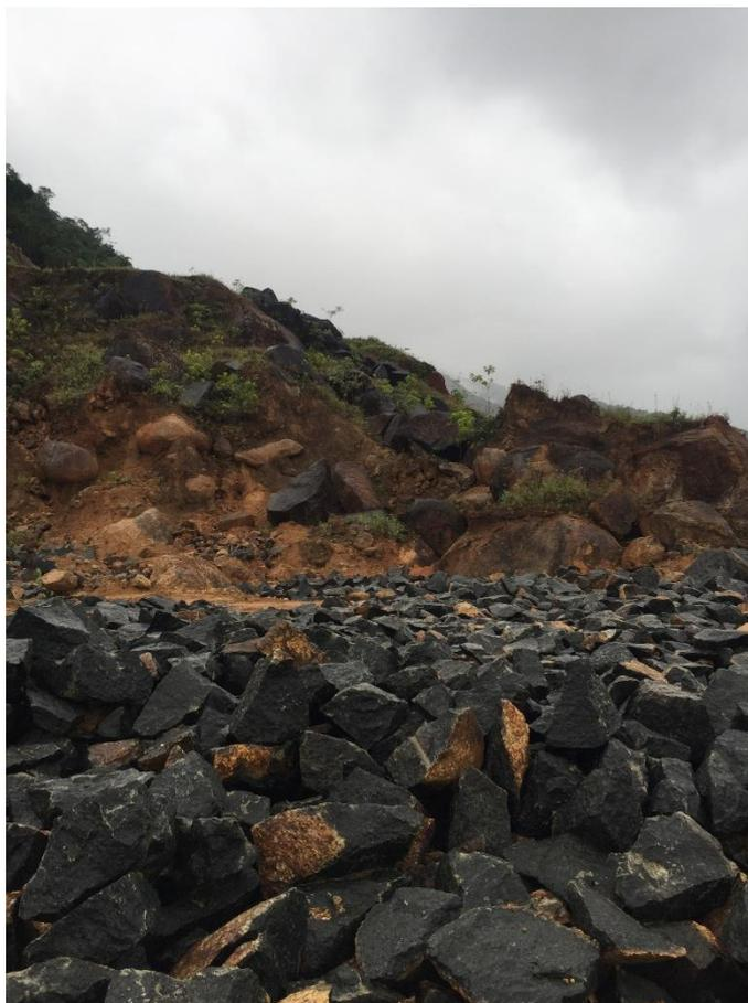
Figura 20 – Área de estocagem dos blocos removidos da frente de lavra e prontos para a alimentação do britador primário.
